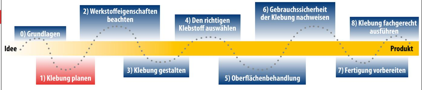
Bild 1: Was von der Idee bis hin zum Produkt zu berücksichtigen ist (Bild: Fraunhofer IFAM)
