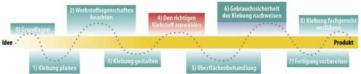
Bild 1: Was von der Idee bis hin zum Produkt zu berücksichtigen ist (Bild: Fraunhofer IFAM)
