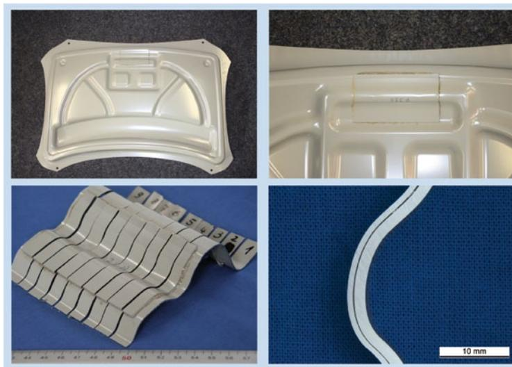
**BILD 1** Motorhauben-Innenteil mit aufgeklebter lokaler Schlossverstärkung (oben links); die mit PASA-Technologie aus dem Fraunhofer IFAM aufgebrachte Schlossverstärkung im Detail nach Beschichtung durch kathodische Tauch-Lackierung (KTL) und KTL-Ofen (oben rechts); Probenpräparation (unten links) und Detailansicht der Schlossverstärkung im Querschliff (unten rechts) zur Visualisierung der Homogenität der Klebfuge (alle Bilder: © Fraunhofer IFAM)
