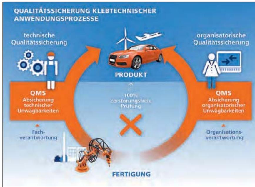
>>4: ISO 9001 - technische und organisatorische Qualitätssicherung als „Umweg“ zur Sicherstellung der Produktqualität bei speziellen Prozessen, weil Qualität nicht zu einhundertprozentig zerstörungsfrei prüfbar ist (Bild: Fraunhofer IFAM)
