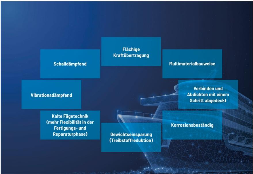
**Bild 1** Vorteile des Klebens für den Schiffbau
