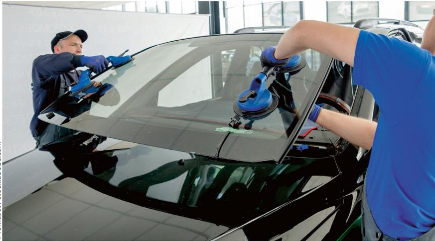
**Bild 4** Reparatur einer defekten Autoscheibe.
